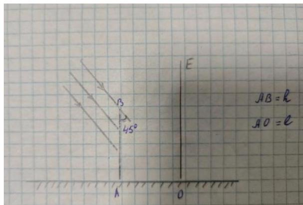
5. У акваріум з рідиною помістили пластиковий круг. На середину круга спрямували промінь від лазерної указки. Визначити за малюнком показник заломлення рідини відносно повітря
